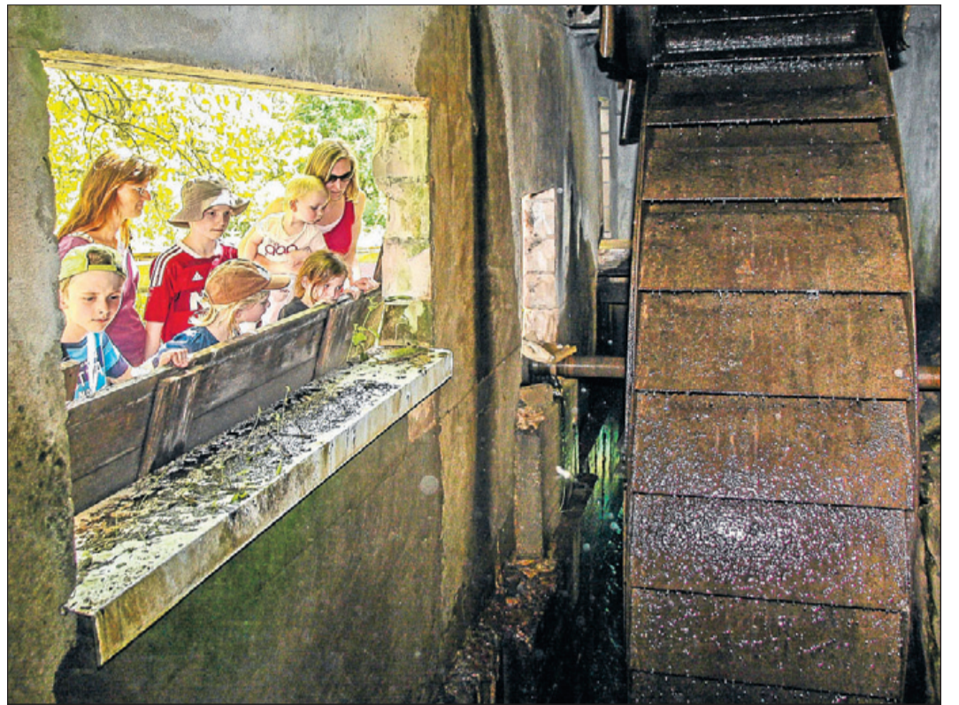
Viele große und kleine Gäste bestaunen am Pfingstmontag das Mühlenrad in der Schweizermühle. Mit der Wasserkraft wird auch der Walzenstuhl angetrieben, den Ludwig Angermeier den Besuchern ausführlich erklärt. Fotos: Klier
